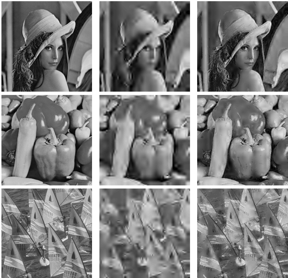
Abbildung 4.6: (Links) Originalbild; (Mitte) 9/7 -Tensorprodukt-Wavelet-Transformation mit 500 von Null verschiedenen Waveletkoeffizienten (Nnu); (Rechts) Hybridmethode mit 500 von Null verschiedenen Waveletkoeffizienten.
